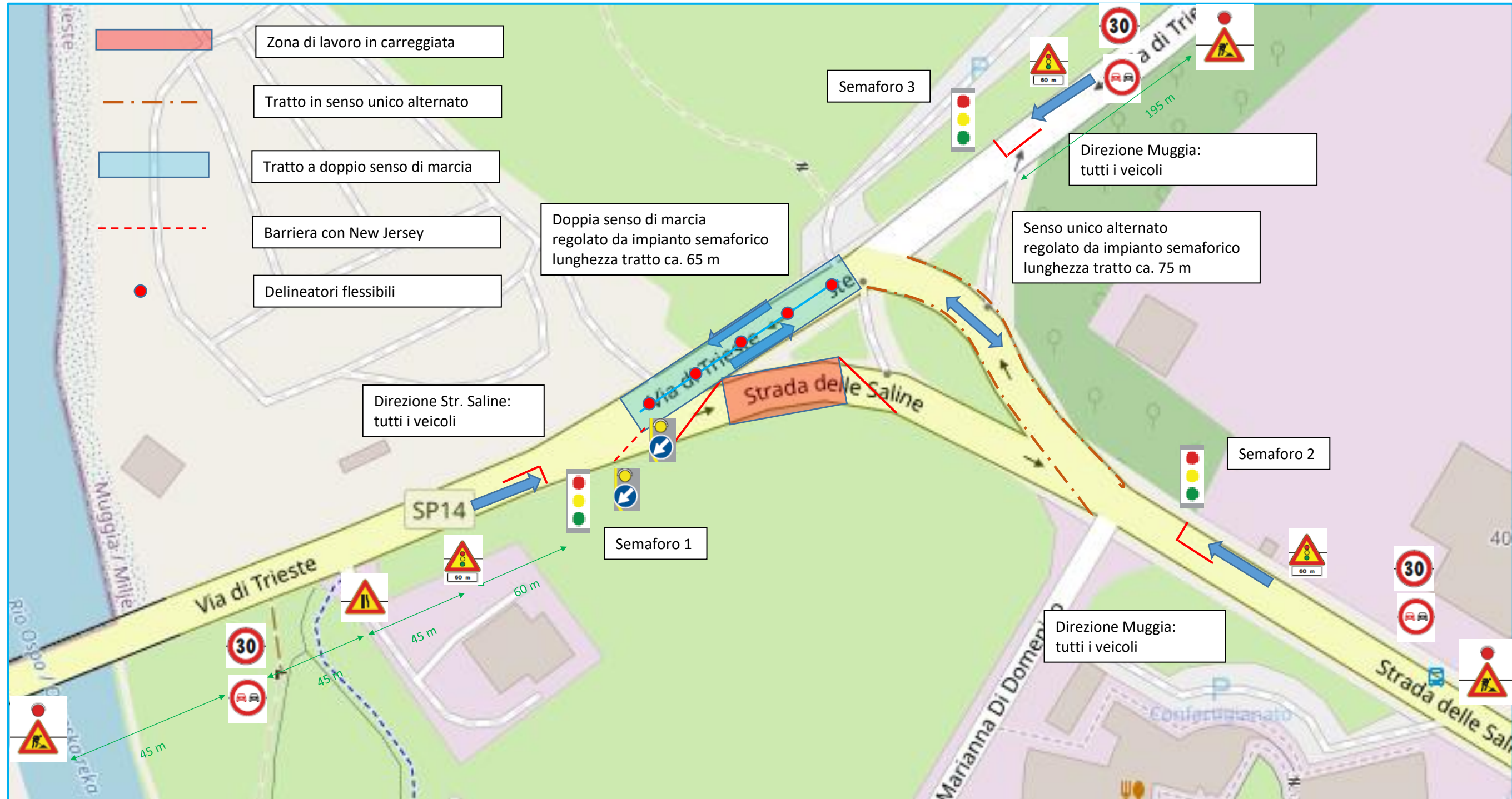
Tavola 4 - SCHEMA SEGNALETICA LUNGO INNESTO S.P.14 / STR. SALINE – ORARIO NOTTURNO DALLE 22:00 ALLE 7:00
